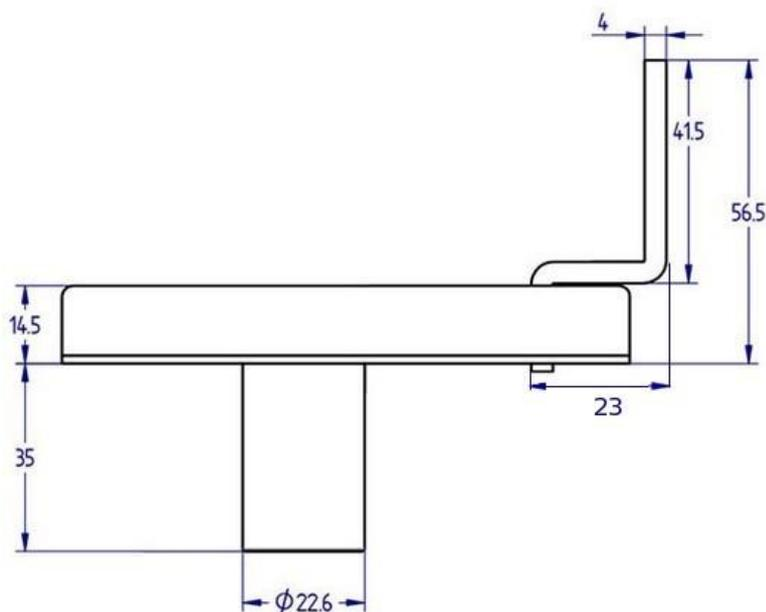
Verrou et gâche en inox AISI 304 - Cylindre laiton chromé avec goupilles et ressorts en inox AISI 303.
